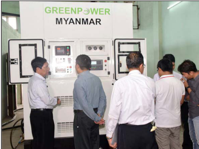
Generator နှင့်တွဲဖက်ကာ Silent Type Gen Set အဖြစ် အဆင့်မြင့်တင်ထုတ်လုပ်ထားသော 220 KW နှင့် 140 KW Gen Set များ စမ်းသပ်မောင်းနှင်နေမှုအား ကြည့်ရှုစစ်ဆေးစဉ်။
